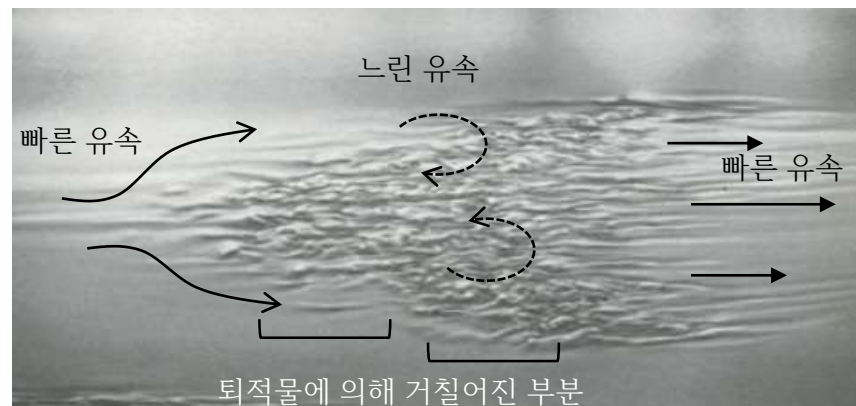
유체의 흐름(Top view) : 거칠어진 표면부위에서 난류(Turbulent flow)가 형성되어 느린 유속이 되며 부착물이 증식됨
