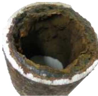
▷ 배관 내부의 부식에 의한 철 산화물 및 미네랄 염에 의한 파울링
