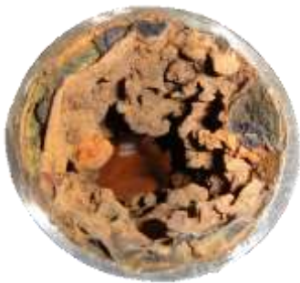
▷ 배관 내부의 부식에 의한 철 산화물 및 미네랄 염에 의한 파울링
